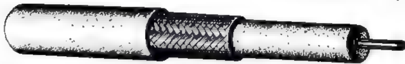
الشكل ٣٢ - خط محوري ، عازله مصنوع من مادة لدنة ( بلاستيك ) .
